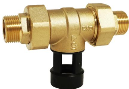
Comme le précise la norme EN1717, le disconnecteur à zone de pression réduite non contrôlable type CAa protège les réseaux d'eau potable des retours d'eau pollués.
