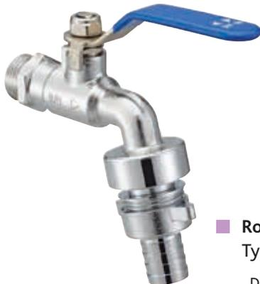
La norme EN 1717 prévoit qu'un robinet de puisage extérieur avec raccord au nez pour branchement d'un tuyau d'arrosage doit être protégé par un disconnecteur. Le robinet HA quart de tour intègre donc la fonction de robinet de puisage mais aussi de disconnecteur HA.
