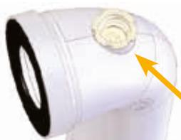
Le bouchon multifonction Ø40 se transforme en raccord pour flexible Ø32 (le fond peut facilement être poinçonné à l'aide d'un tournevis)
